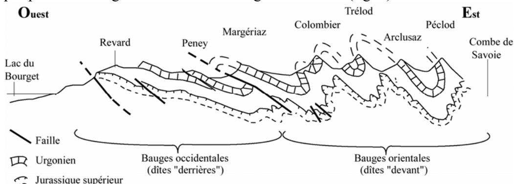
Figure 2 : Coupe simplifiée du massif des Bauges, (d'après M. Gidon (<http://www.alpes-geol.fr>) in Denavit 2005).
